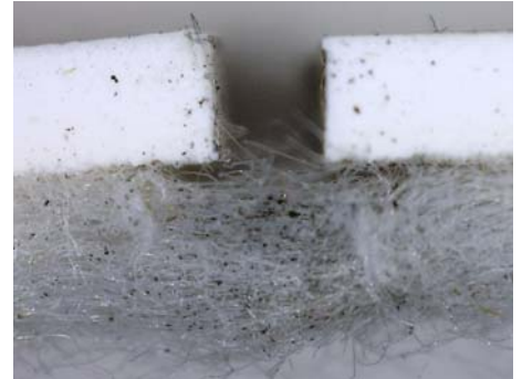
Abbildung 02: Rissquerschnitt bei EVALON, 1,5 mm, mit unterseitiger Vlieskaschierung.
